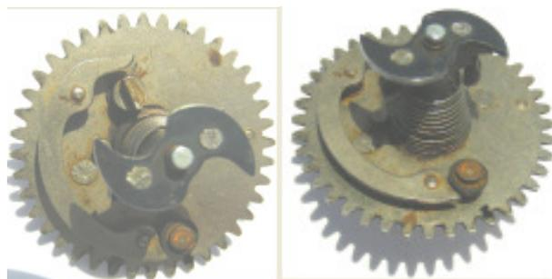
**Bild 13 Comptometer H, Flügelscheibe mit Halbring und Drehfeder**
