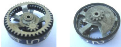
**Bild 19 Burroughs Zählrad (links Planetenrad1 bei 5, rechts Schneckennase fest bei 2)**
