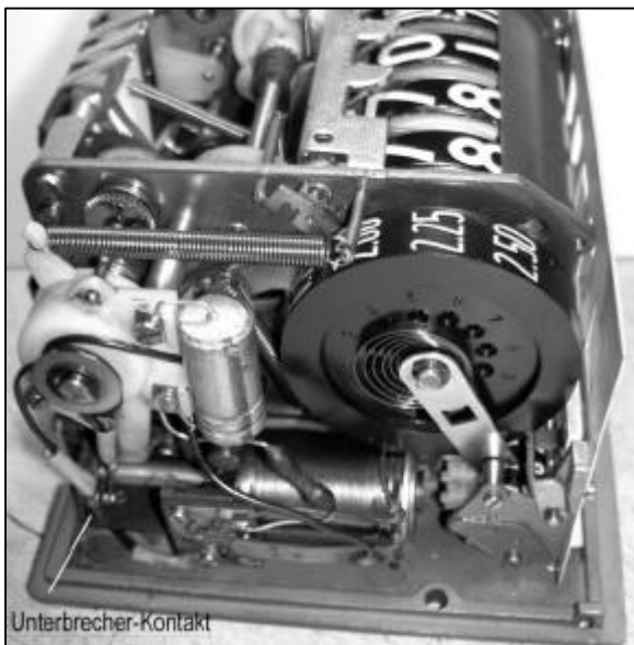
Abb. 13 : Unten querliegend die Spule. Der senkrecht angeordnete Kondensator vermeidet Funkenbildung beim Öffnen und Schließen der Kontaktfedern
