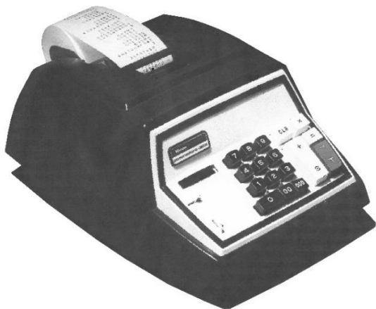
Abb. 18: Commodore 302, die Mechanik entspricht im Wesentlichen dem Ricoh-Modell Ricomac 301.
