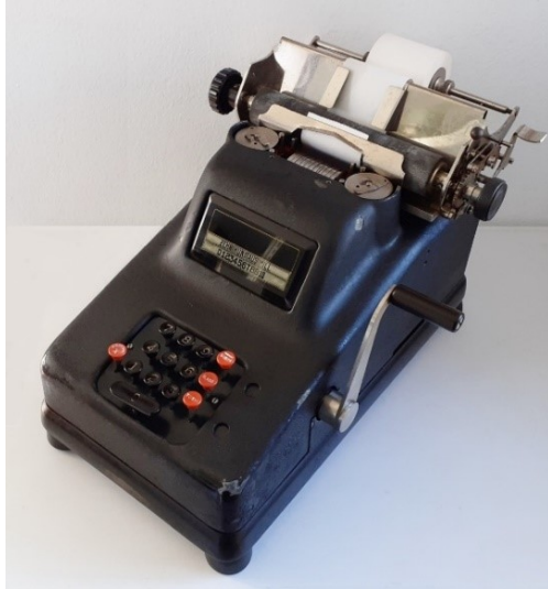
Abb. 1: Beispiel einer Sundstrand Zweispezies-Maschine: Klasse Junior / Modell 10020, mit Handantrieb.
