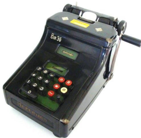
Die Zehntasten-Maschine ist eine Erfindung von August Friedrich Pott (\* 17.01.1903 in Barmen), der um 1938 als Chefkonstrukteur des Technischen Büros für Rechenmaschinen erwähnt wird<sup>2</sup>. Die Mechanik wurde erstmals in dem Patentantrag DE701253 vom April 1934 für eine „druckende Addiermaschine mit Stellradwagen“ beschrieben<sup>3</sup>. Der zeitgleich gestellte zweite Patentantrag DE652667 betrifft die Zehnerschaltvorrichtung der Maschine.
