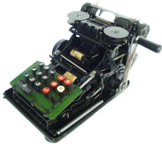
Beim Drücken der Zifferntasten der Zehnertastatur werden die Vertikalbewegungen der Tastenschäfte in Horizontalbewegungen der zugeordneten Stellhebel umgesetzt. Mit dem Vorlauf eines Stellhebels wird die damit ausgelöste Drehbewegung eines Stellrades so begrenzt, dass sein Drehwinkel proportional dem Eingabewert ist.
