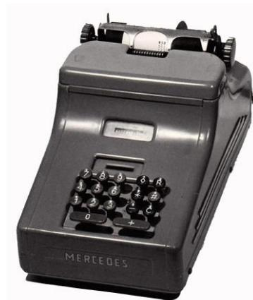
Die Grundfläche der Maschine (L x B) wurde verlängert. Waren es bei dem Vormodell A 51 noch 310 x 193 mm (ohne Papierrolle und ohne Hand-Zughebel), so kommt das neue Gehäuse auf 340 x 190 mm. Die größere Länge entsteht dadurch, dass die Papierrolle jetzt im Gehäuse liegt (Abb. 11).
