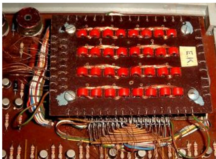
Abb. 15: Huckepack-Baugruppe der Datenspeicher- Ansteuerbaugruppe über dem Datenspeicher
