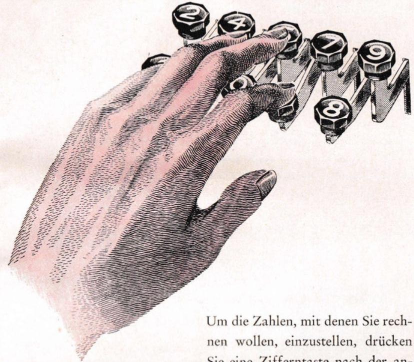
Um die Zahlen, mit denen Sie rechnen wollen, einzustellen, drücken Sie eine Zifferntaste nach der anderen in der Reihenfolge der Ziffern von links nach rechts. Um daher z. B. die Zahl 1365 einzustellen, drücken Sie zuerst die Zifferntaste 1, dann 3, 6 und 5. Die entsprechende Ziffer erscheint jeweils sofort im Einstellwerk.
