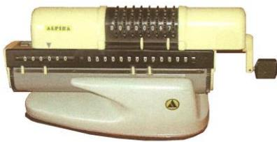
Beim Drehen des gerändelten Einstellringes (1) wird auch die Kurvenscheibe (2) gedreht. Dies bewirkt ein seitliches Umklappen der Stifte (3) in Arbeitsstellung. Beim Antrieb der Hauptachse werden die Einstellungen verriegelt, das Einstellwerk gedreht und die waagrecht (axial) liegenden Sprossen treten in die Bahn von Zwischenrädern, die den eingestellten Betrag in das Resultatwerk übertragen.
