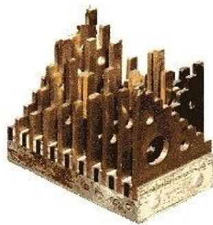
Einmaleinsblock der Millionär-Vier-spezies-Maschine mit Einer- und Zehnerplatten für das direkte Multiplizieren.
