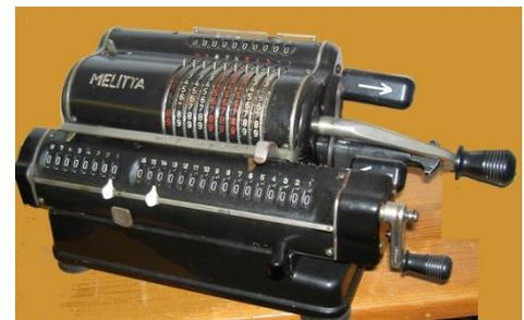
Direktantrieb, zwei Daumentasten, je eine vor bzw. hinter der Kurbel, Rückübertragung
