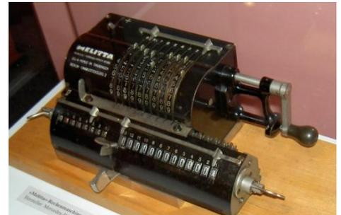
Schlittenschaltung mit waagrecht Daumentaste und langer, vorgelagerter Drucktaste - Schlitten steht unter Federspannung zwecks automatischem Tastschritts nach links
