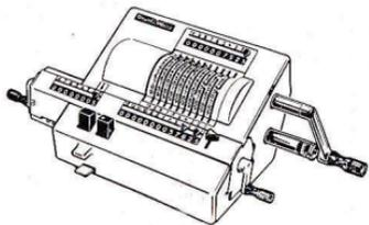
Multiplikationsmaschine mit Resultatrückübertragung für Handbetrieb.
