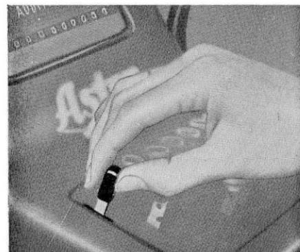
Stellenanzeiger oder durch einen Kurbelzug überzeugen, den man beim Rechnen allerdings nicht auszuführen braucht, da er nur diesem Kontrollzweck dient. Ist beim Einsetzen einer vielstelligen Zahl nur die letzte oder vorletzte Ziffer falsch angeschlagen, so genügt zu deren Löschung, daß man den Hebel nach vorn drückt. In diesem Falle wird bei jedem kräftigen Vorziehen des Hebels nur die jeweilig letzte Ziffer gelöscht, was man bei Modell C auch an
