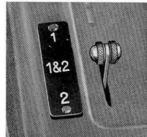
Diese Maschine besitzt, wie schon der Name andeutet, zwei Zählwerke. Das obere Zählwerk ist ein Addier- und Saldierwerk wie bei Modell C, das untere Zählwerk ist nur für Addition eingerichtet. Beide Zählwerke arbeiten getrennt voneinander, sie können aber auch durch Hebelstellung zu gemeinsamer Arbeit verbunden werden. Die Stellung des Zählwerkssteuerhebels ist immer 1 & 2.
