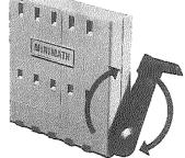
Kurbelarm nach oben umdrehen zum Subtrahieren-Dividieren und zum Löschen. Kurbelarm nach unten umdrehen zum Addieren -Multiplizieren und zum Übertragen ins Zählwerk.
