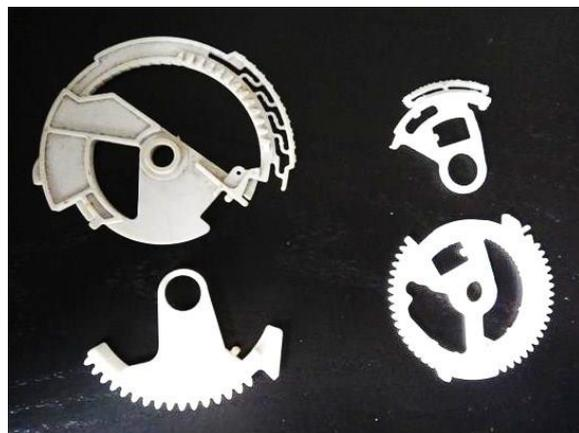
Ein Unterschied besteht im kleineren Drucksegment der OAM-Version, bei dem Vorläufer AM 209 trägt das Zahnsegment den Anschlag für das Abfragen des Stiftschlittens.
